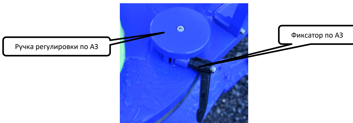
Рисунок 3.3.1.6 б - Ручка регулировки по азимуту.
