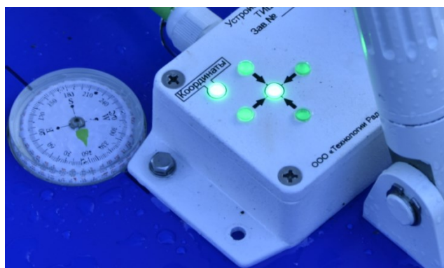
Рисунок 3.3.1.2 в – Индикация при правильно установленном горизонте ОПУ
