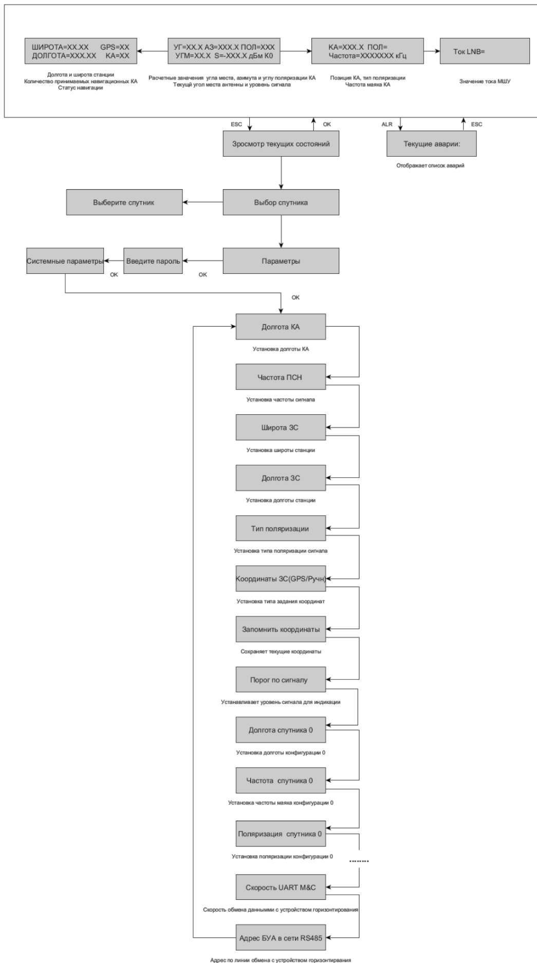
Рисунок 3.3.1.9 – Структура меню контроллера наведения
