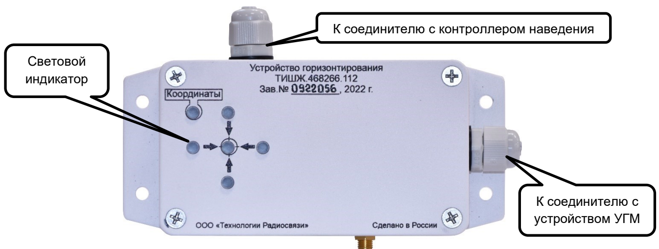
Рисунок 10 – Общий вид устройства горизонтирования ТИШЖ.468266.112
