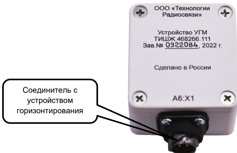
Рисунок 11 – Общий вид устройства УГМ ТИШЖ.468266.111
